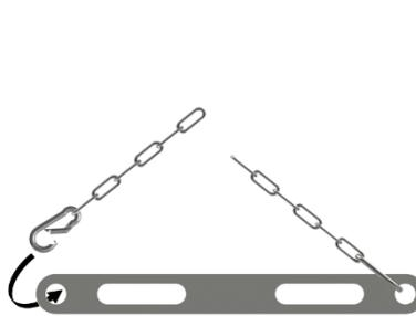
② Nehmen Sie nun die beiden Schweißketten und klippen Sie diese mit Hilfe der soeben angebrachten Feuerwehrring an die Stahlstrebe.
