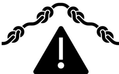
④ Achten Sie darauf, dass bei der Ausführung von Schritt 3 dieser Kurzanleitung die Schweißketten nicht verdreht, verdrillt oder verknötet ist!
