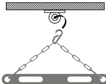
⑤ Nun können Sie die Traverse bestimmungsgemäß an eine geeignete Verankerung befestigen. Klippen Sie hierzu den oberen Feuerwehrring entsprechend in die Verankerung.
